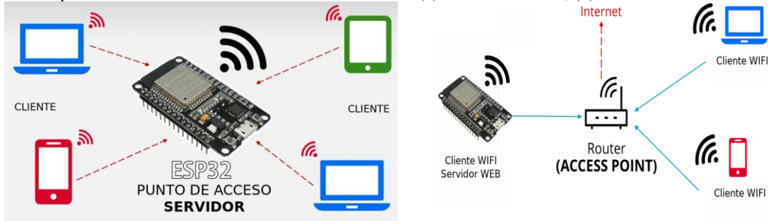
Figura 4. Arquitecturas de conexión inalámbrica del ESP32. (a) Punto de acceso; (b) Cliente en una red inalámbrica.
