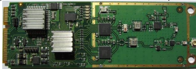
Figura 5. Módulo LoRa mPCIe LG9271 de Microchip/Occammd.
