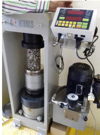
Figura 8. Ensayo a esfuerzo de compresión simple
