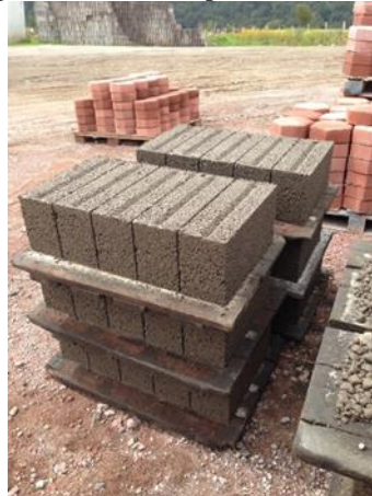
Figura 4. Blocks en proceso de secado
