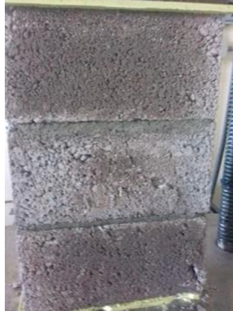
Figura 11. Falla de pila después de la carga
