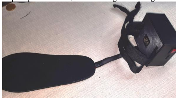
Fig.8. Plantilla inteligente para pie diabético, sistema integrado con agarradera ajustable en el tobillo.
