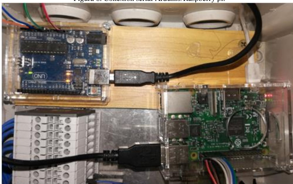
Figura 6. Conexión serial Arduino/Raspberry pi.
