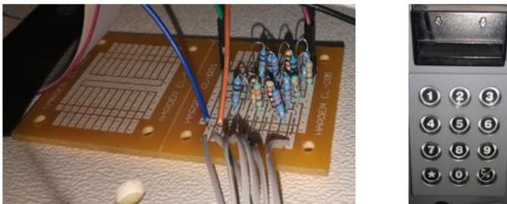
Figura 5. Circuito R-2R y teclado de máquina expendedora.
