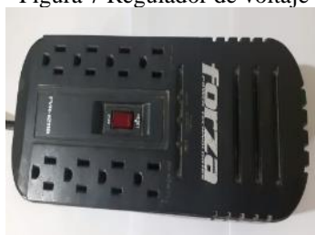
Figura 7 Regulador de voltaje
