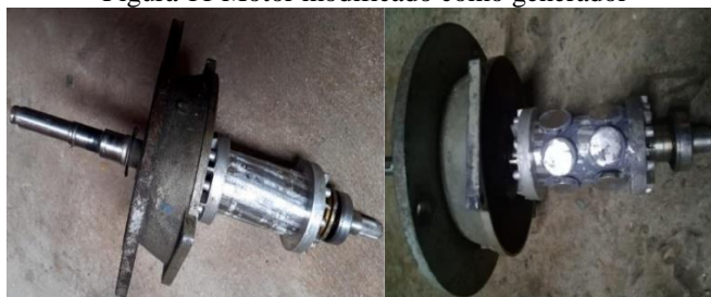
Figura 11 Motor modificado como generador
